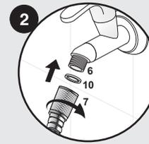
Rosqueie a extremidade da Mangueira Flexível (7) juntamente com a Guarnição (10) no Niple de entrada da Mangueira Flexível (6), como mostra a ilustração.
