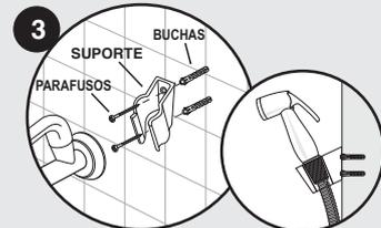
Com o Corpo do Registro (4) instalado, fixe o Suporte da Ducha Manual (8). Fure a parede utilizando uma broca de 5mm a uma altura de sua conveniência. Coloque as respectivas Buchas (9) nos furos e fixe o Suporte com Parafusos (8). Obs.: Tome cuidado para não furar tubulações de água, gás, rede elétrica, etc.
