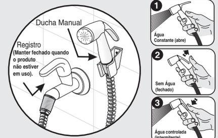
Para utilizar a Ducha Higiênica FAME, retire Ducha Manual do Suporte (8), abra o Registro (5), acione o Gatilho em uma de suas posições - 1 constante (abre), 2 sem água (fechado) e 3 água Controlada (intermitente) - e regule pelo Registro (5) a vazão de água conforme desejado. Após a utilização, feche o Registro (5) e despressurize a Mangueira Flexível acionando a Ducha Manual.
