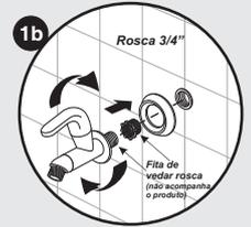
Aplique fita de vedar rosca no Niple de entrada (3) e rosqueie o Corpo do Registro (4) na conexão hidráulica, **utilizando somente as mãos**, e apertando-a convenientemente.
