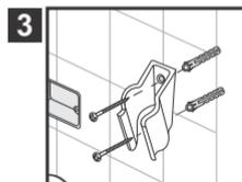
Com o aparelho já fixado à parede, agora instale o suporte (16) da Ducha Manual, que pode ser fixado a uma altura de sua conveniência. Para fixar as buchas use brocas de Ø 5mm, tomando cuidado para não furar a tubulação de água ou a rede elétrica.
