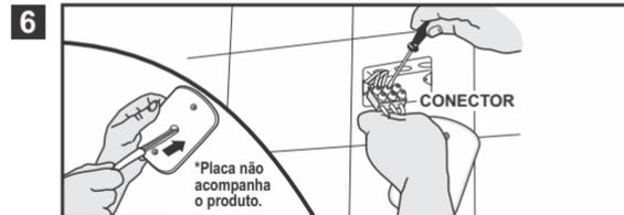
Primeiro certifique-se novamente de que o circuito elétrico que alimentará a Flex Ducha está desligado, após isso proceda a conexão dos cabos, utilizando preferencialmente o Conector (18) **nunca faça uso de plugues e tomadas para essa instalação**. Note que nos circuitos fase/neutro, o cabo branco deve ser conectado à fase e o cabo azul deve ser conectado ao neutro. **Nos circuitos fase+fase não há esta distinção.**
